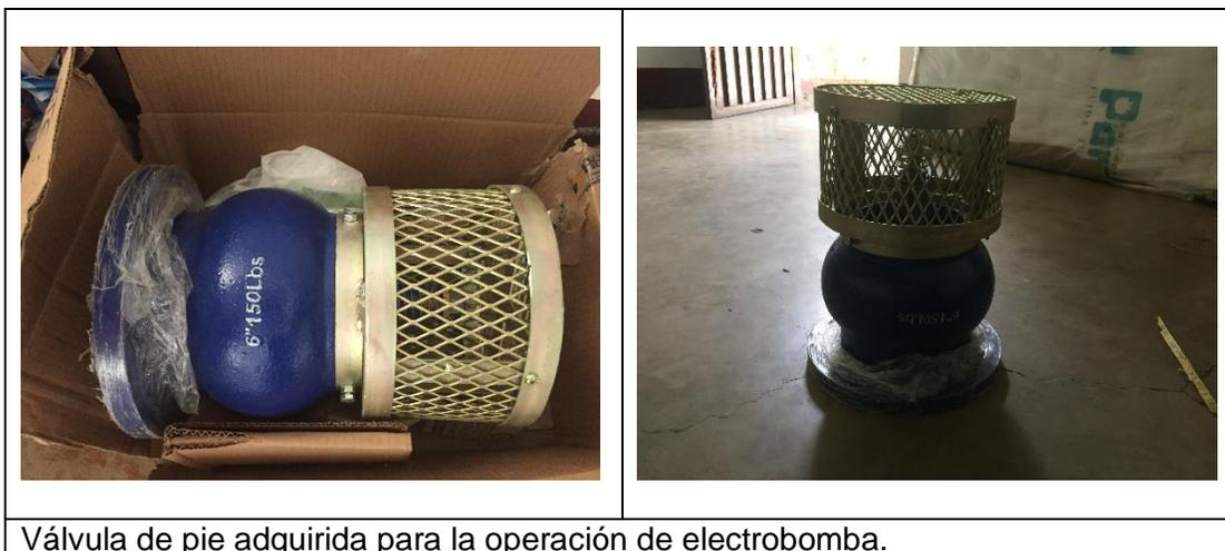
Válvula de pie adquirida para la operación de electrobomba.
