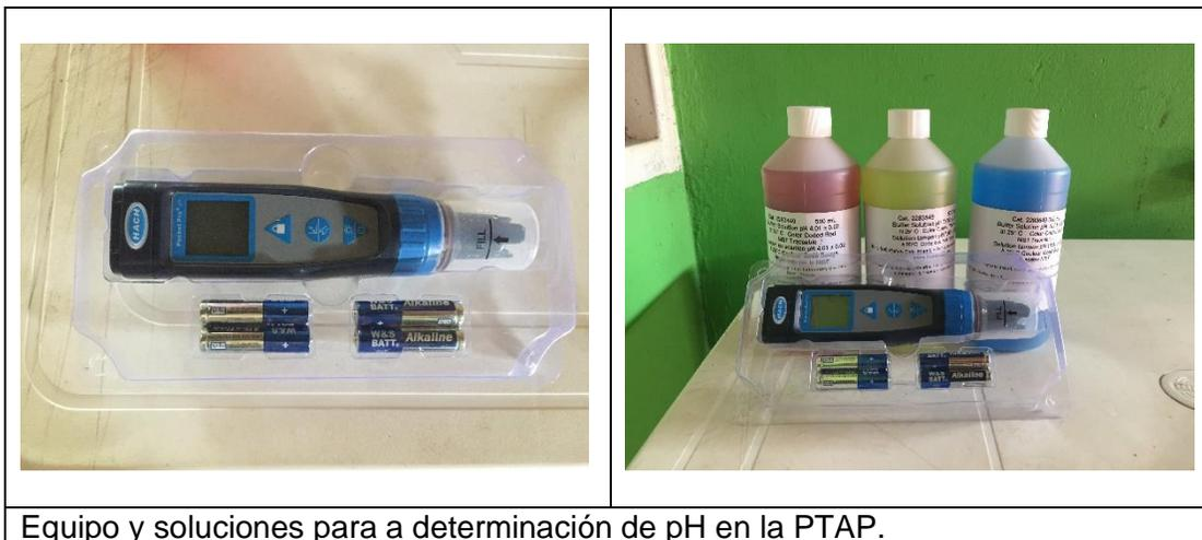
Equipo y soluciones para a determinación de pH en la PTAP.
